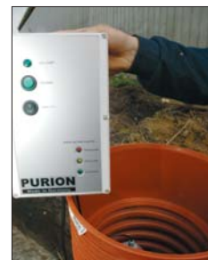
UV-lyset styres og overvåges i denne kontrolkasse, som monteres inde i mink-stalden (Foto: Stine Pedersen).
