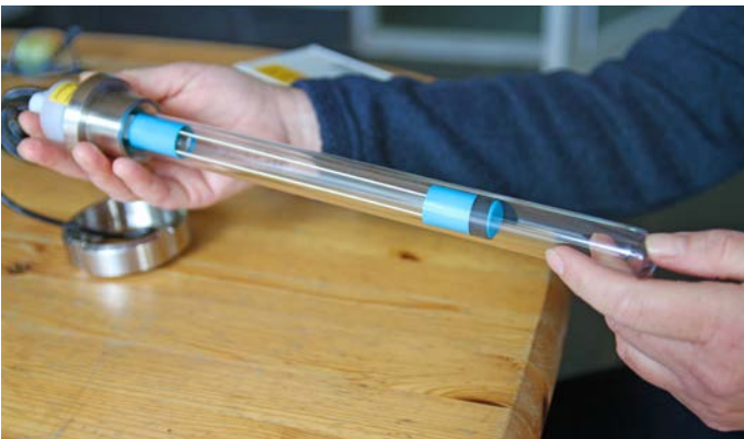
Hvis man har meget okker i vandet, skal man engang imellem hive det kvartsglas ud, som beskytter pæren, for at rense det.
