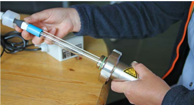
Pæren skal udskiftes efter cirka 10.000 timer, og er let at skifte. Det er dog vigtigt at man slukker inden man tager pæren ud, da lyset ellers vil give svejseøjne.
